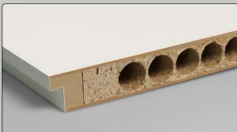
**Röhrenspan-Mittellage:** Standard Mittellage bei ASTRA Türen. Die Röhrenspan-Mittellage sorgt für hohe Stabilität und gute Schallschutzwerte bei moderatem Türblattgewicht.
