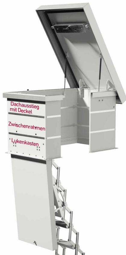
Optimal belüftet und bequem – Der DOLLE Flachdachausstieg bietet den idealen Weg nach oben. Der besondere Vorteil liegt in der modularen Bauweise mit leichten Komponenten. Eine Einzelperson kann sie tragen und montieren. Nach dem Einbau der Bodentreppe DOLLE clickFIX®, DOLLE clickFIX® vario oder DOLLE F30 werden ein oder mehrere Rahmen auf den Lukenkasten gesetzt. Zum Schluss wird nur noch der Deckel montiert.
