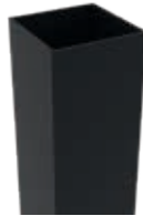
Torpfosten 90x90mm mit 4mm Wandstärke. In Verbindung mit dem Wandprofil Art.2647 kann ein Sichtschutzzaun am Torpfosten beginnend montiert werden.
