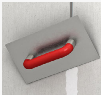
Fugen und Befestigungsmittel verspachteln
