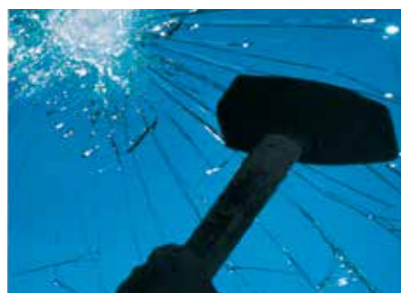
Verbundsicherheitsglas (VSG). Eine Folie bindet bei einem Angriff von außen die Splitter.
