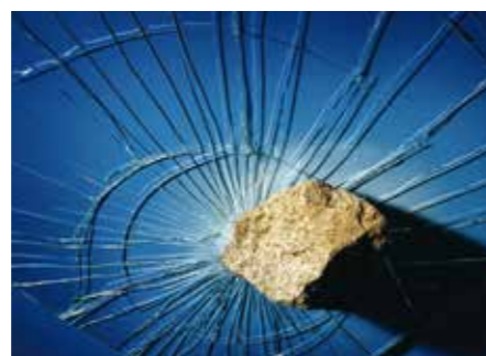
P4A-Sicherheitsglas. Die Scheibe hält selbst Wurfgeschossen stand.
