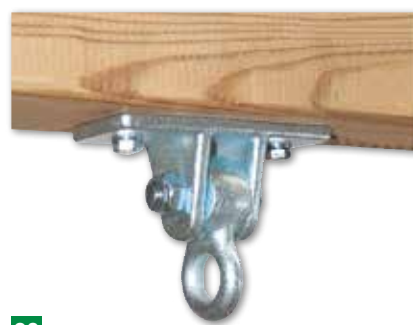
28 Schaukelhaken verzinkt, für Schaukeln, mit Messinglager und Sicherheitsmutter zur Aufhängung an der Unterseite der Querstange. Schraubenlöcher Ø 13 mm, Öse für die Befestigung von Seilen oder Ketten mit Ø 20 mm. Gesamtmaß 130 x 50 x 100 mm.
