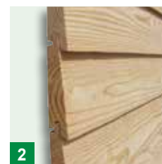
2 Fassadenprofil 29/15 x 141 mm, mit Nut und Feder, glatt gehobelt, technisch getrocknet
