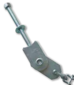
23 Schwinghaken verzinkt, mit Kugellager in einer 10 mm dicken Stahlplatte. Nylonlager (außen Ø 15 mm, innen Ø 6 mm) für die Befestigung von Ketten, Gesamtlänge 160 mm, Gewindestange mit M14-Sicherheitsmutter, Schäkel mitgeliefert.
