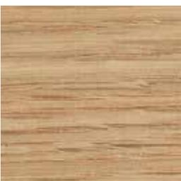
**Amerikanische Weißeiche** ist ein besonders edles und wertvolles Hartholz mit einem Kern von blass hellbrauner bis leicht rötlicher Farbe. Das exzellente Stehvermögen, seine Widerstandsfähigkeit gegen Pilz- und Wurmbefall – Resistenzklasse 2<sup>1)</sup> – und die hohe Druck- und Biegefestigkeit verleihen dem Holz eine nahezu unbegrenzte Lebensdauer.
