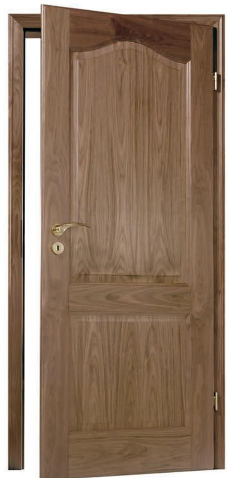
Massiv Füllungs-Stiltür MF/2C, am. Nussbaum lackiert, Inline-Zarge 65 mm, Drücker R25 Messing poliert
